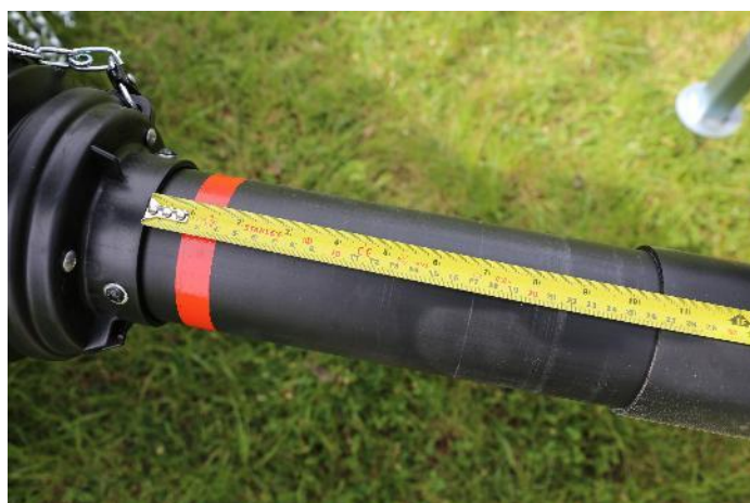
Figur 6 - Minimum fri bevægelse for input PTO – 260 mm
