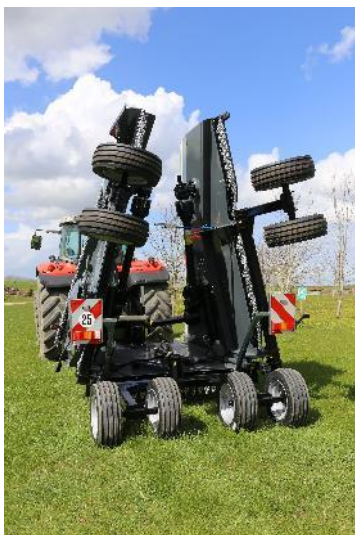
Figur 12 - Transportposition med fastholdelsesrem (Tiger 725 vist)
