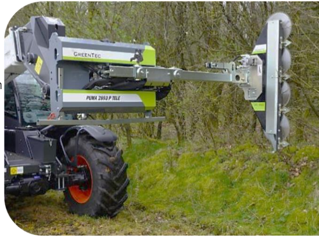
Beispiel eines an einem Teleskoplader montierten PUMA 2803 Tele-Multiträger mit der LRS 1602 Astsäge.
