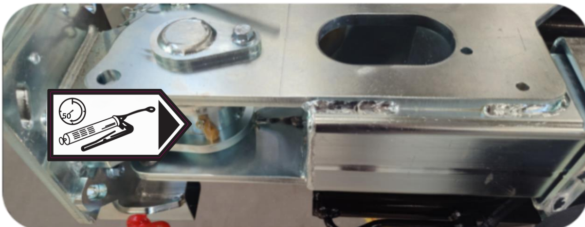
Position des Schmiernippels am Ende des PUMA 2803 Tele-Multiträger-Teleskoparms
