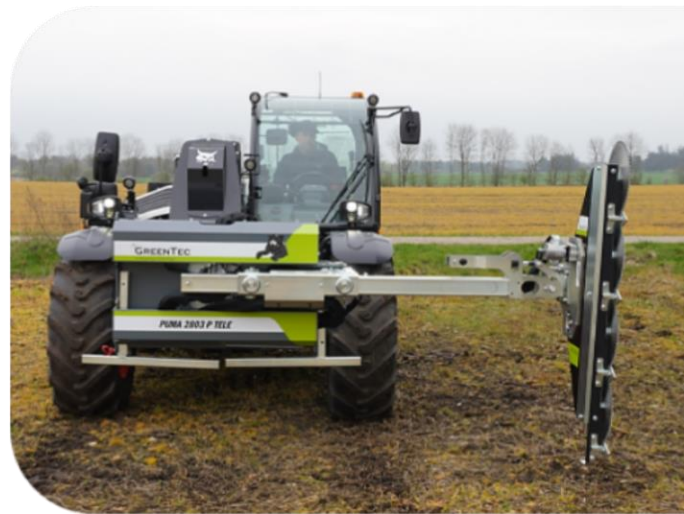
PUMA 2803 Tele-Multiträger Im Einsatz mit HL 152 Heckenshere
