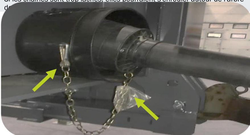
Les chaînes de sécurité doivent être montées aux deux extrémités de l'arbre de transmission !
