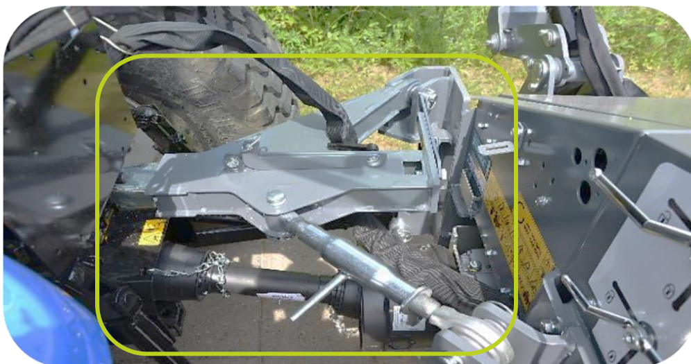
Montage en 4 points avec le système d'attelage à 4 points et fixation à la barre d'attelage supérieure
