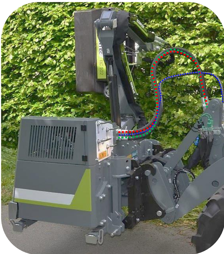
Raccordements hydrauliques entre Scorpion 3-430 Basic et le véhicule
