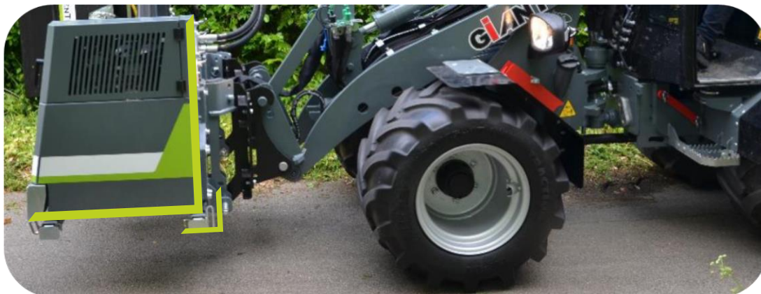
La Scorpion 3-430 Basic soulevée et montée à l'aide d'un collier de fixation sur un système de levage de véhicule en position verticale
