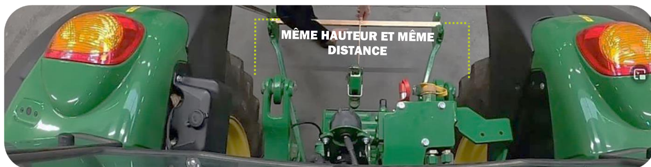
Réglage des bras de levage du véhicule à la même hauteur et à la même distance
