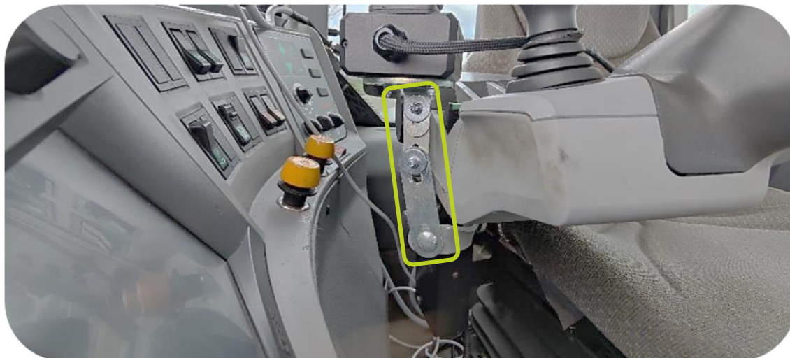
Joystick avec supports de montage inclinés, boulonné sur la console/l'accoudoir du véhicule
