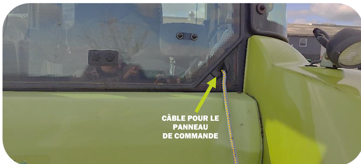
Acheminement du câble de l'épareuse à la cabine du véhicule
