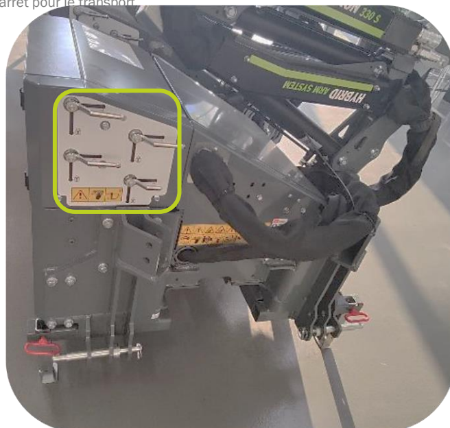
Emplacement des vannes de blocage / d'arrêt pour le transport sur l'épareuse
