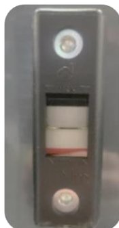
Indicateur du niveau d'huile hydraulique dans le réservoir
