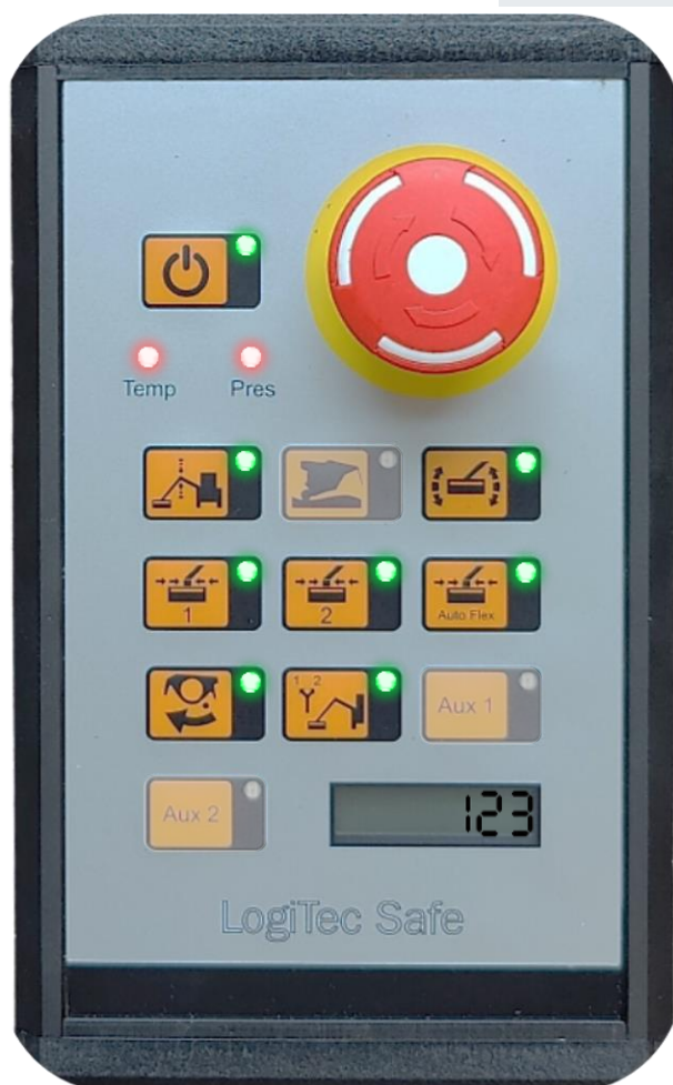
Panneau de commande LogiTec Safe de l'épareuse Scorpion 3-430 : (tous les modèles Standard et Plus)
