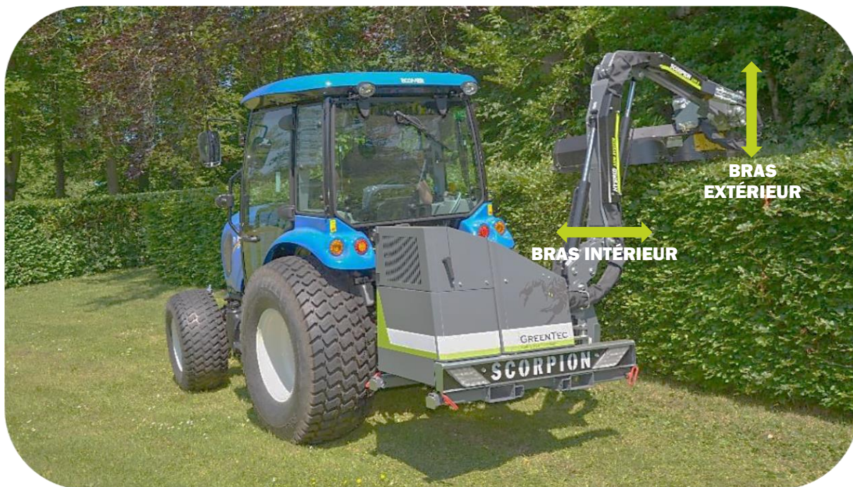
Épareuse Scorpion 3-430 en cours d'utilisation avec la fonction de guidage non-parallèle
