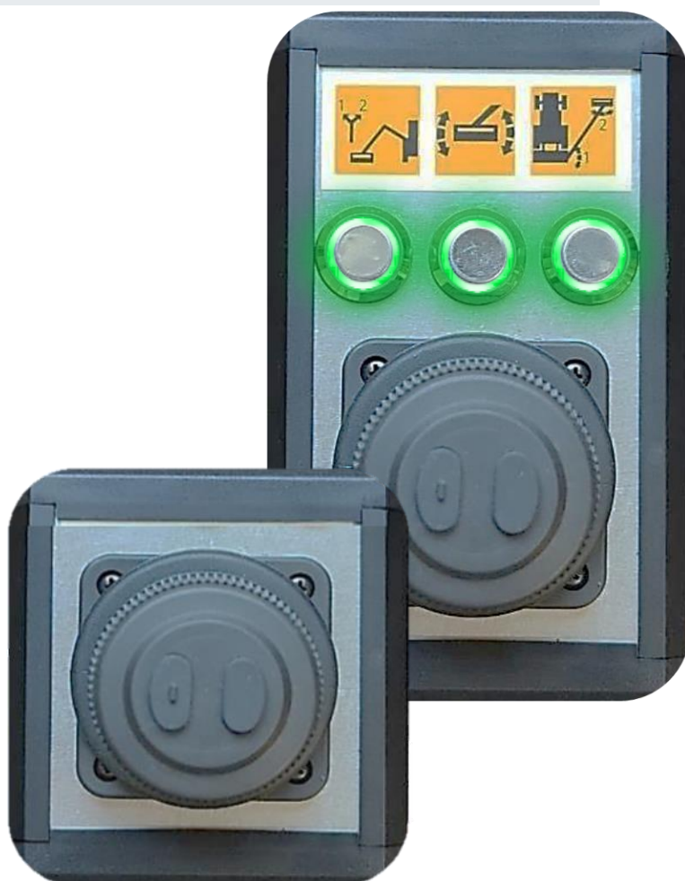
Joystick de l'épareuse Scorpion 3-430 : joystick standard/basic (à gauche) et joystick Plus avec fonctions supplémentaires (à droite).
