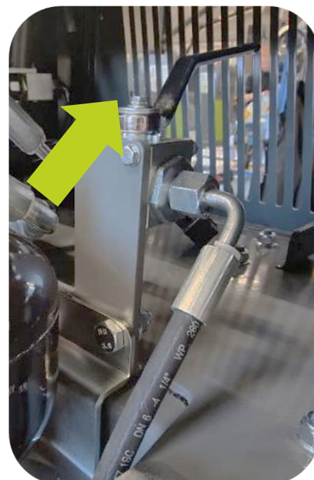
Vanne d'arrêt (1x) pour le changement des outils de fixation
