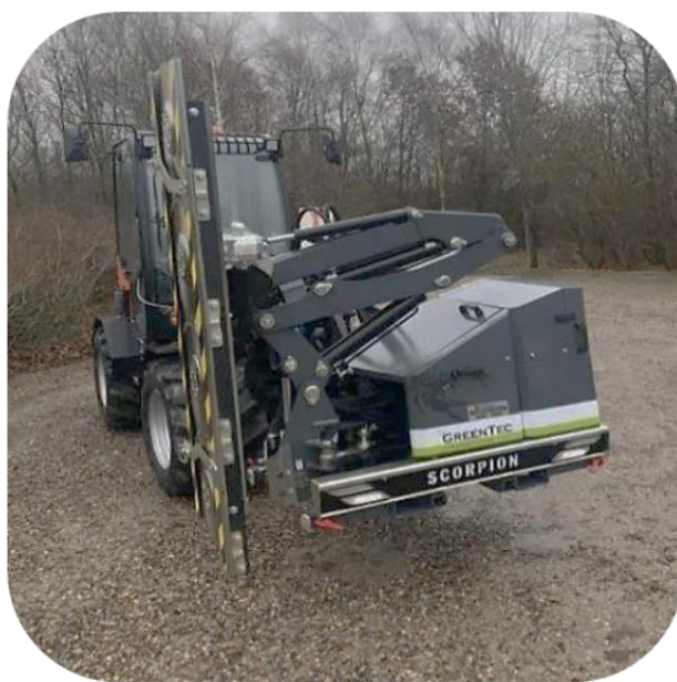
Exemple de position de transport : épareuse Scorpion 3-430 et lamier LRS 1402 (montée à l'avant) : dispositif de protection recouvrant les lames de la scie
