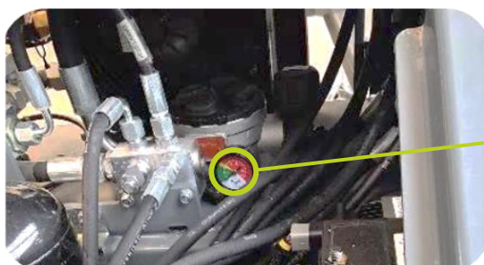
Manomètre/indicateur de remplacement du filtre
