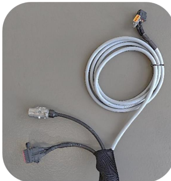
Connexions (3 pièces) des épaveuses Scorpion 3-430 au véhicule
