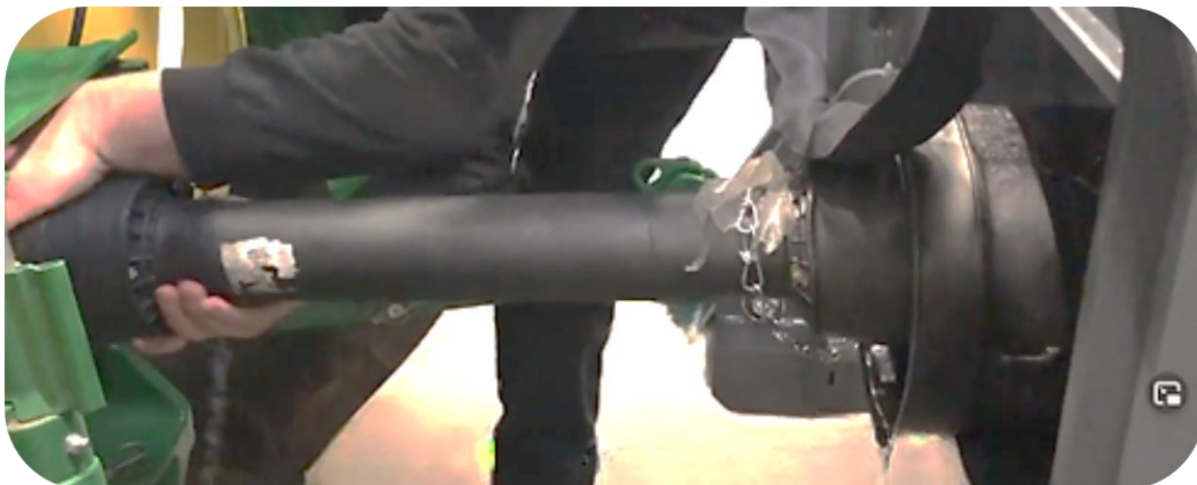
Installation de l'arbre de transmission entre l'épareuse Scorpion 3-430 et le véhicule
