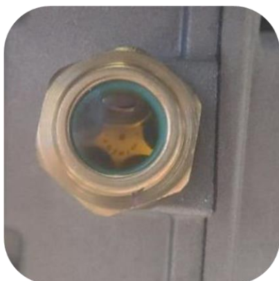
Indicateur de niveau pour la vérification du niveau d'huile sur la boîte de vitesses
