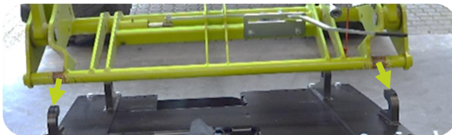
Exemple de montage d'un système de levage de véhicule à l'aide d'un coupleur / adaptateur spécial
