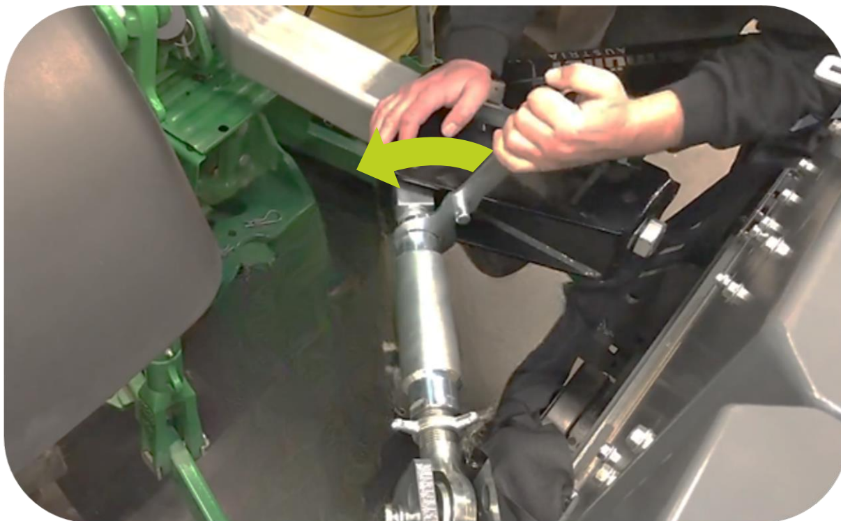
Réglage de la barre d'attelage supérieure transversale servant à serrer le stabilisateur entre le véhicule et l'épareuse
