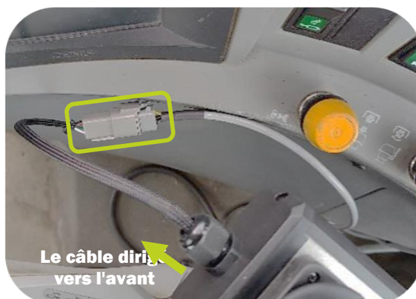
Connexion du joystick à l'aide d'une fiche/câble au panneau
