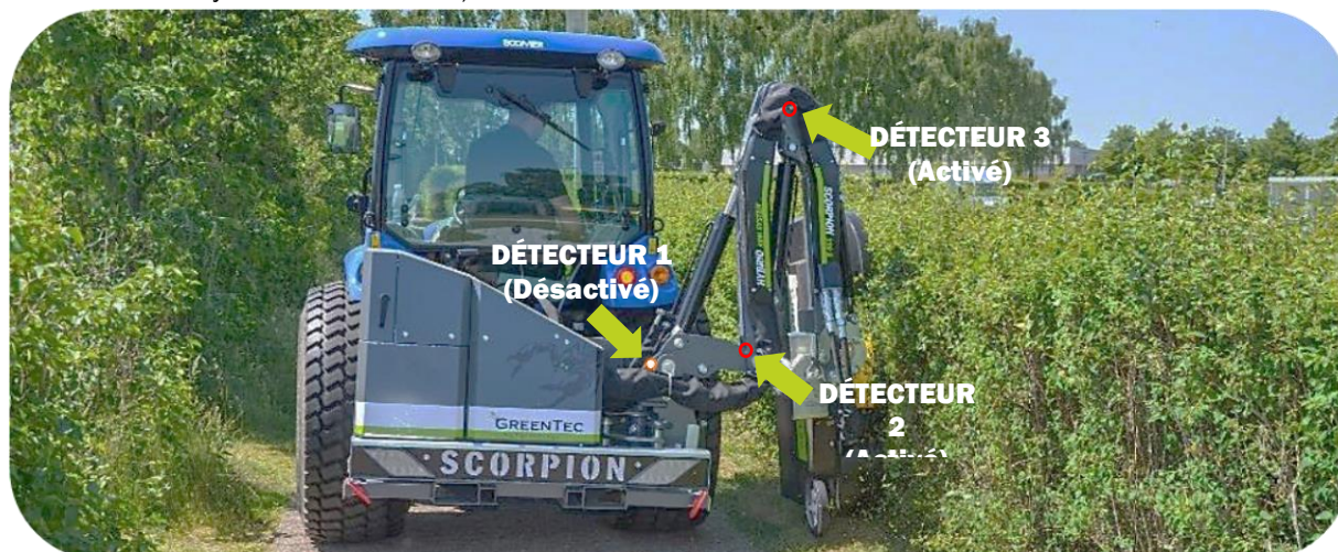
2 des 3 détecteurs de sécurité bloqués et donc activés : épareuse Scorpion 3-430
