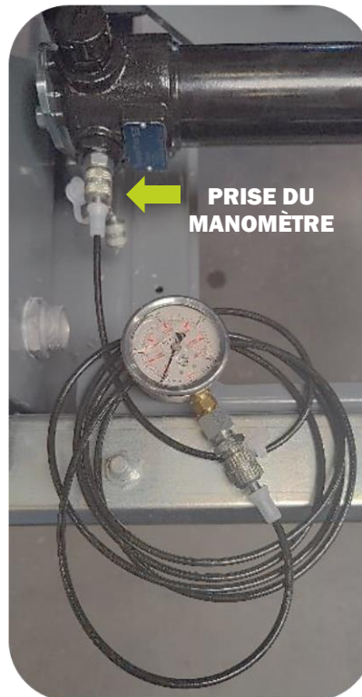
Raccordement d'un manomètre à la sortie du filtre à haute pression
