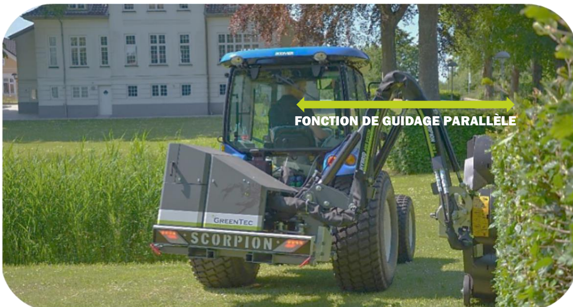
Épaveuse Scorpion 3-430 en cours d'utilisation avec la fonction de guidage
