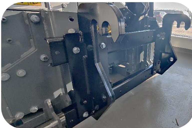
La structure de montage et le coupleur sont montés sur l'épareuse Scorpion 3-430 à la livraison.
