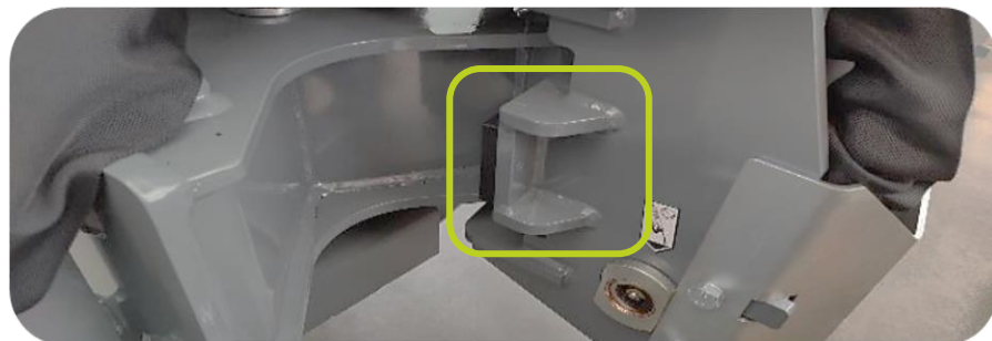
Butée permettant de limiter la rotation du bras de l'épareuse Scorpion 3-430
