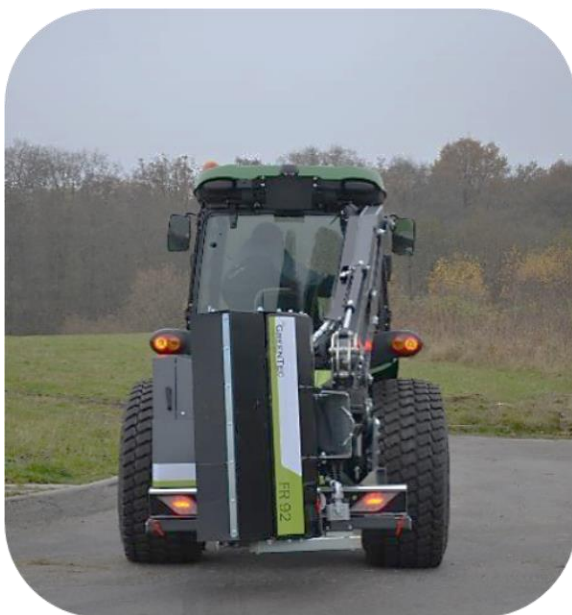
Exemple de position de transport : épareuse Scorpion 3-430 et débroussailleuse FR 92 (montée à l'arrière) : tous les feux d'éclairage sont dégagés sur l'épareuse et le véhicule
