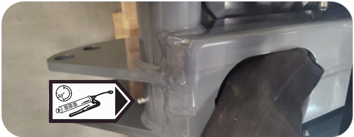
Position des Schmiernippels an der Innerseite des PUMA 2803-Multiträger-Schwenkarms
