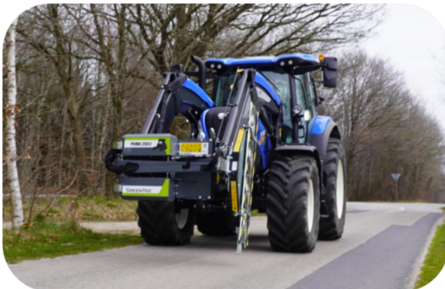
Beispiel für Transportstellung: Beleuchtung frei am Fahrzeug, freie Sicht, mit am Anbaugerät montierten Sicherheitseinrichtungen, zum Fahrzeug gerichtet für maximale Verkehrssicherheit.
